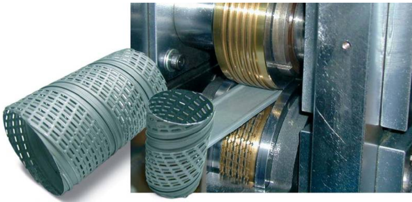
Пробивные ролики, изготовленные из BÖHLER K190 MICROCLEAN
